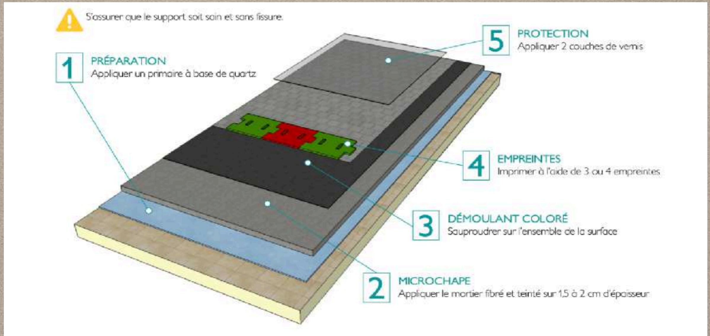
C'est la micro chape (réalisée sur une dalle existante) qui confère l'aspect définitif à votre béton imprimé.
